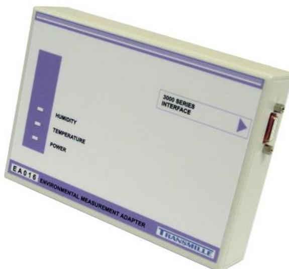
Адаптер EA016 обеспечивает простое в использовании решение для мониторинга лабораторного оборудования. Он оснащён надёжным ёмкостным датчиком влажности с линейным выходом и прецизионным встроенным температурным датчиком с выходным напряжением, линейно пропорциональным температуре в градусах Цельсия.
