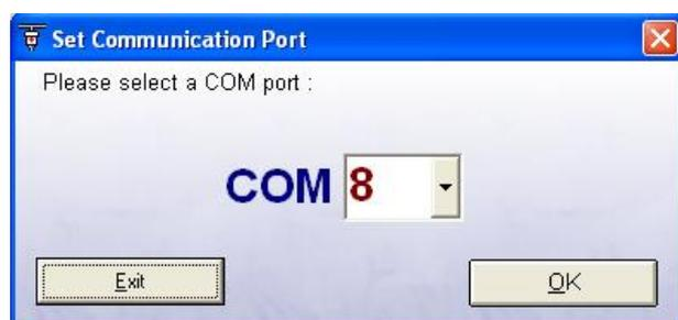
При первом запуске виртуальной передней панели отобразится экран выбора COM-порта. Для продолжения щёлкните кнопкой мышки по COM-порту, к которому подключён Ваш калибратор серии 3000.
