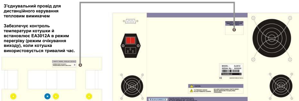
Рис. 3: Підключення дистанційного керування тепловим вимикачем EA3012A до котушкового модуля для струмовимірювальних кліщів до 2000 А EA019 (на замовлення) за допомогою проводу, що входить у комплект.
